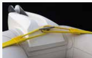
Lasso en composite avec âme métallique
